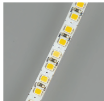
Моноцветные светодиоды SMD 2216 768 шт/м с CRI >90 Шаг резки 12мм.
